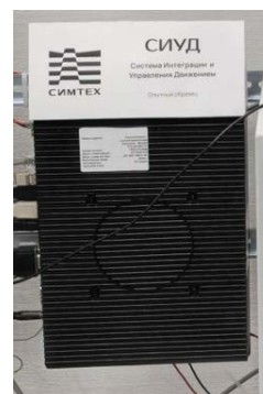
Судовой управляющий компьютер из состава СИУД
