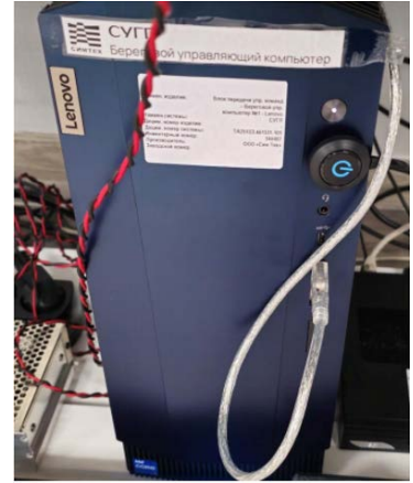
Береговой управляющий компьютер из состава СУГП
